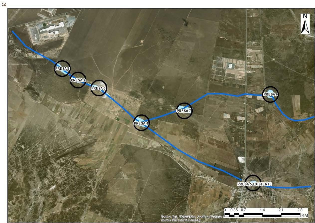
Imagen 17. Detalle de la propuesta de alternativa A de manejo del agua pluvial en la subcuenca N°4, al interior del área del Programa.
